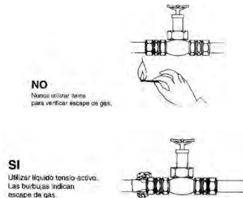
Figura 17. Sistemas de detección de fugas en cañerías de laboratorios
